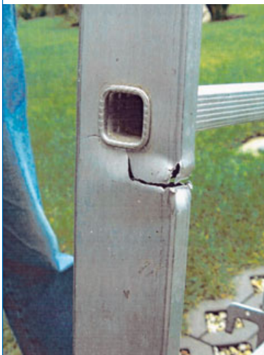
Bild: 51. Stark beschädigte Leiter
